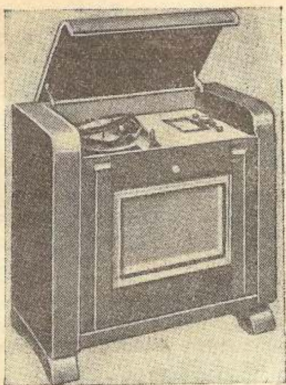
Рис. 5. Приемник, все органы управления которым находятся под верхней крышкой
