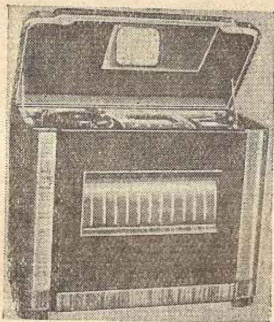
Рис. 13. Телевизионная установка для приема многострочного телевидения, объединенная с всеволновым приемником и автоматическим электрограммофонным механизмом
